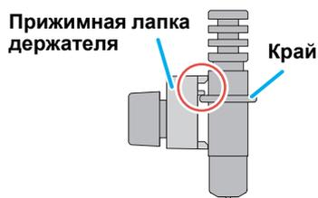
Установка флюгерного ножа для резки картона
