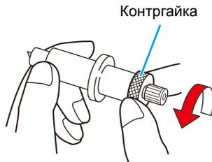
**2** Для регулировки размера выступающей части лезвия резака поверните ручку регулировки.
